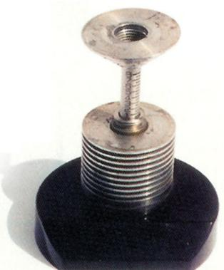
Mengapa tangkai besi tidak masuk ke dalam, bisa berdiri tegak? Karena di dalam logam bulat timbangan itu ada pegas penahan yang telah diperhitungkan, tanpa beban maka nol gram berat, tertulis pada tangkai logam. Demikian pula apabila ada beban suratpos, tertekan ke bawah, tangkai masuk, dan langsung ketahuan berapa berat suratpos beban tersebut.
