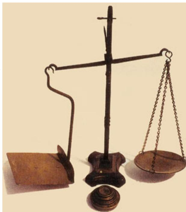
Sistem gerak timbangan pos yang menggunakan hukum keseimbangan vertical bisa dilihat dengan model pendulum atau pemberat yang diayunkan.
